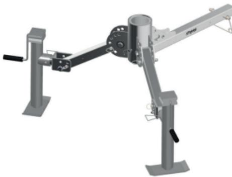
Permite el uso de la Poste Universal con el sistema de gancho de remolque para vehículos.
